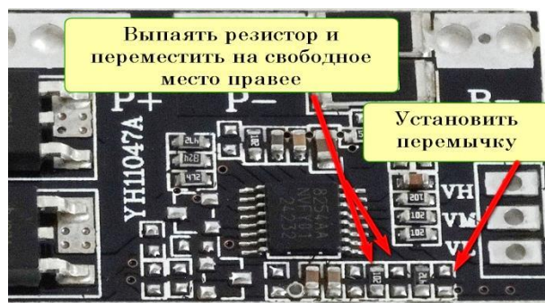
Рис.4 Схема доработки модуля для подключения 3-х аккумуляторов
