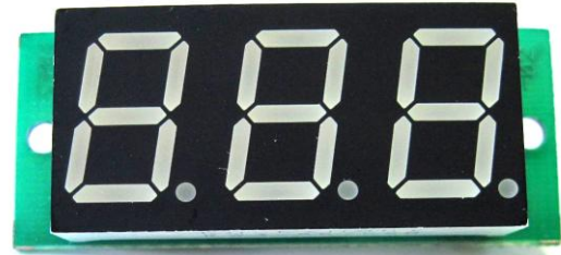
Внешний вид устройства (размер платы 21x48мм)
