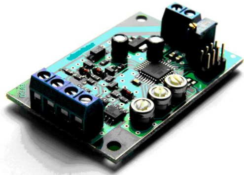
Внешний вид устройства Размер печатной платы 60x42x15 мм
