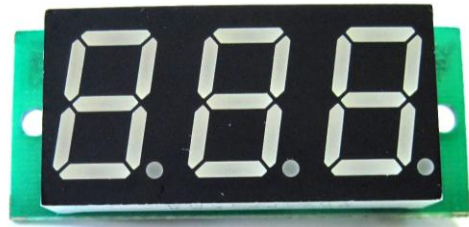
Внешний вид модуля (размер платы 21x48мм)
