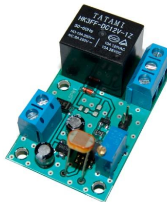
Внешний вид устройства (46x29x20mm)
