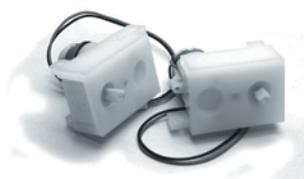
**Блок двигателя с редуктором** – состоит из корпуса с элементами крепления; двигателя постоянного тока, с напряжением питания 4,5 В (максимум 9 В) и потребляемым током 180 мА; редуктора, с передаточным отношением 48:1 и максимальным моментом 4 кг/см.
