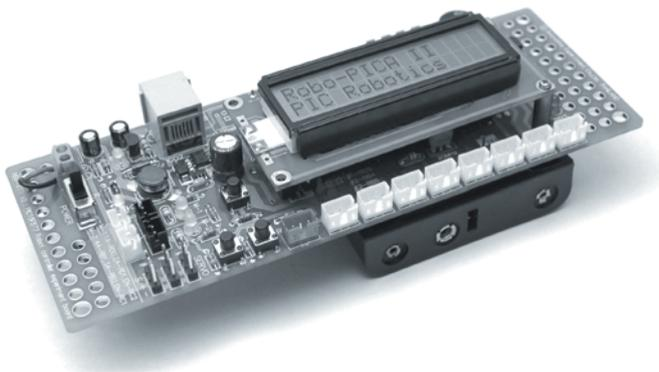
**RBX-877V2.0 PIC16F887** Плата для робототехнических экспериментов
