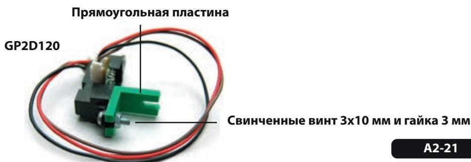
A2.18 Спереди робота, вставьте винт 3x10 мм в центральное отверстие платы RBX-877V2.0 и гайку 3 с верхней стороны платы, как показано на Рисунке A2-22. Не затягивайте винт. Далее, вставьте модуль GP2D120, собранный на шаге A2.17, между головкой винта и платой управления (см. Рисунок A2-23). Затяните винт для фиксации всего вместе.
