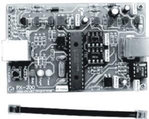
**Плата USB-программатора с ICD2 кабелем**
