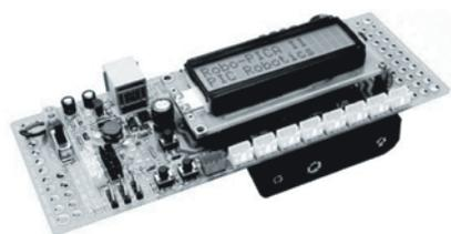
Плата управления RBX-877 на микроконтроллере PIC16F877
