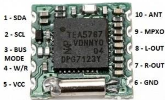
Рис.2 Внешний вид набора с обозначением выводов
