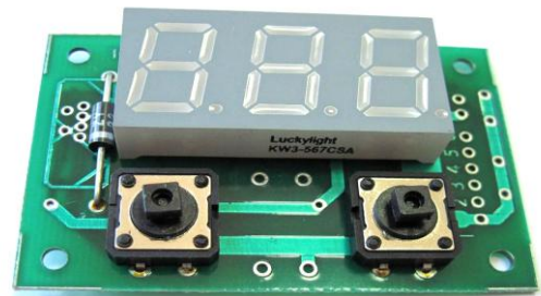
Внешний вид устройства Размер печатной платы с компонентами 58x39x15мм
