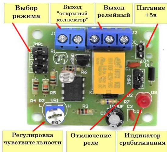
Рис. 1 Схема расположения элементов управления и регулировки
