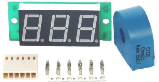
Внешний вид устройства (размер платы 21x48мм)
