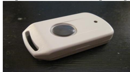
Внешний вид передатчика, размер 32x55x14мм
