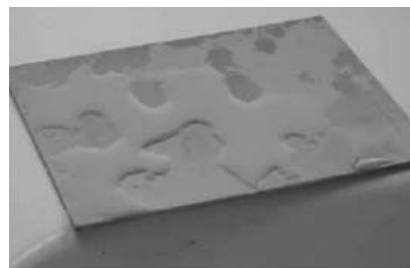
Плохо очищенная поверхность
