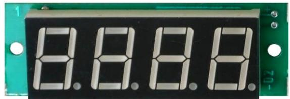
Внешний вид устройства, размер платы 21x69мм
