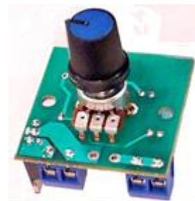
Рис.2 Внешний вид устройства Размер печатной платы 38x38мм База крепления винтами М3 30мм
