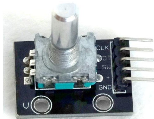
Рис. 2 Внешний вид энкодера
