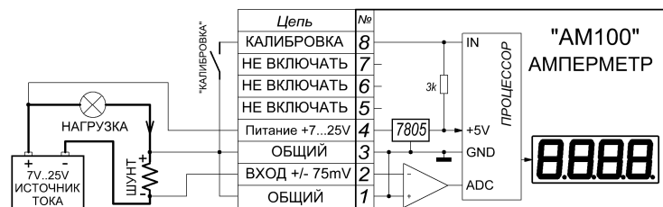
Рис.1 Схема подключения амперметра и шунта с питанием от источника тока.
