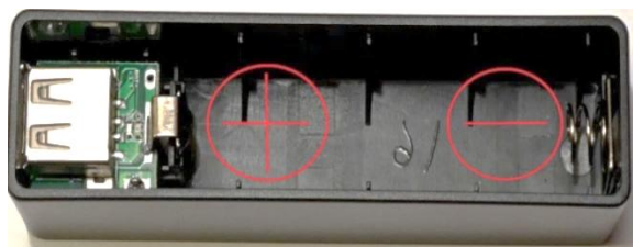
Рис. 1 Условное обозначение полярности аккумулятора внутри корпуса
