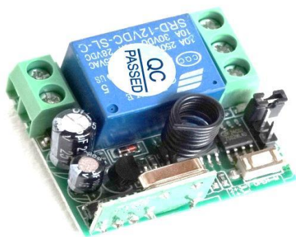
Рис.1 Схема расположения контактов на блоке приемника. Размер 32x35x20мм
