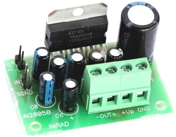
Рис.2 Внешний вид усилителя Размеры печатной платы 50x33мм
