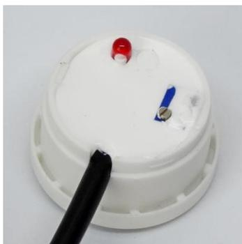
Рис.1 Регулировка чувствительности под крышкой
